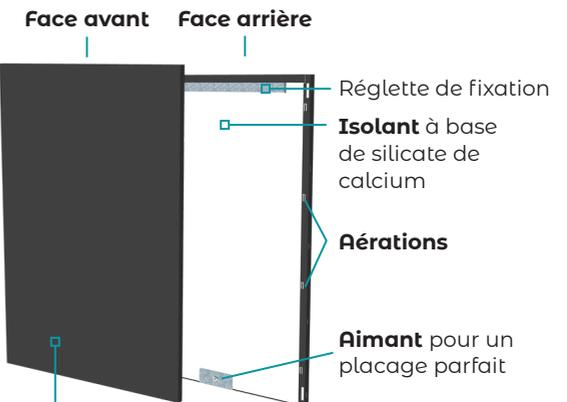
Façade en **acier** électro-zingué, ventilée en partie haute et sur les côtés.
